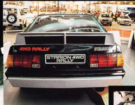
(上)リヤスポイラーにキレイに組込まれたオイルクーラー (右上)スベアタイヤを固定しているのはけん引ロープだ。グッドアイデア！ (右)エンジンルーム (右下)ホイールとタイヤ
