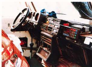
ナビ計器はVLTのラリーコンピュータとツイントリップ
